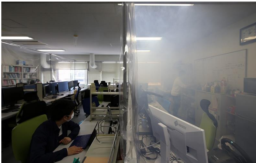
ビニールシート遮蔽によってマイクロ飛沫が滞留する様子(特殊スモークによる再現実験)
