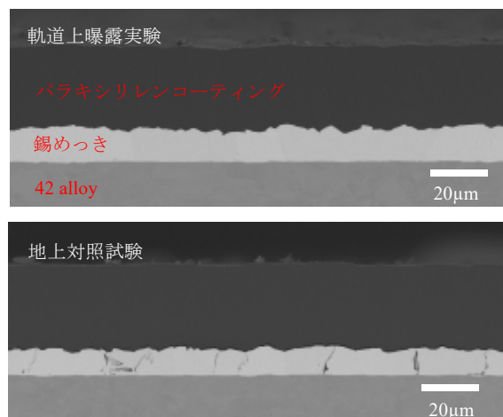
図 7 軌道上曝露実験及び地上対照試験 3 年目，パラキシリレンコーティングした試験片曲げ板（基板：42alloy）における断面 SEM 観察結果
